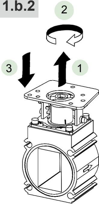
Heben Sie die Kupplung etwa 5 mm an (1).
