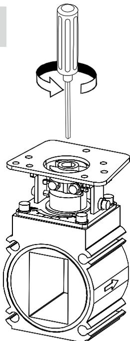
**Umbau der VKP-Kupplung für SQN30/SQN72, 45°-D-Welle**
